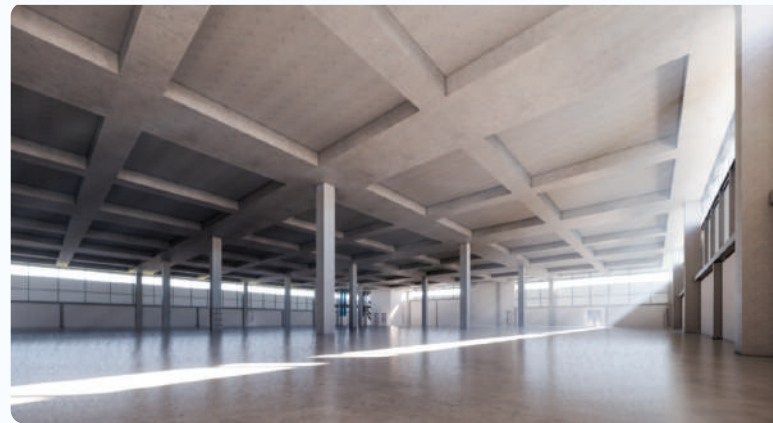
Mô hình 3D thiết kế kết cấu sàn dự ứng lực
